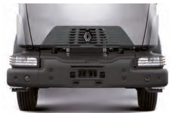
ALL STEEL BUMPER (D) for intensive use.
